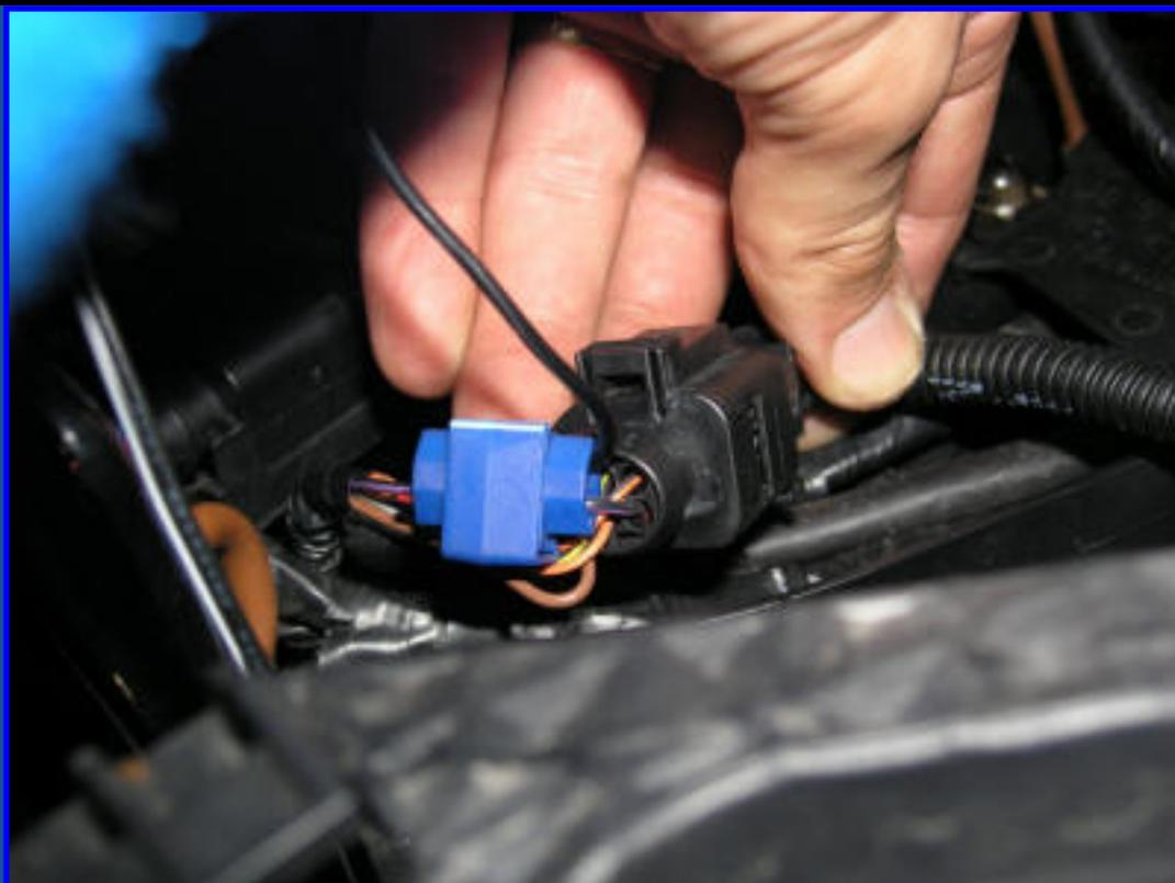
Pour le connecteur 2 il suffit de démonter le phare de débrancher le connecteur
