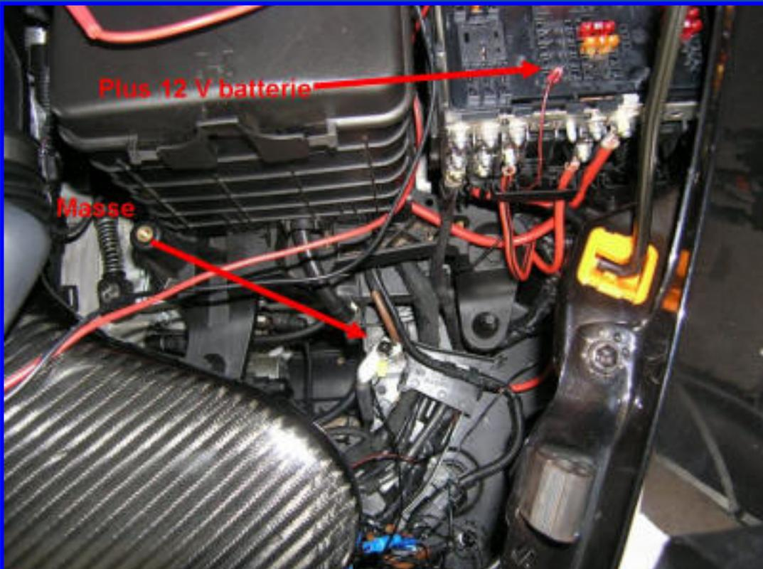
Le plus 12 V situé dans le boîtier à fusible à droite de la batterie
