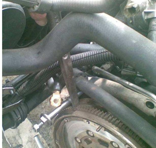
Après faut déterminer si l'ensemble volant bi-masse, mécanisme, disque, et butée sont à changer
