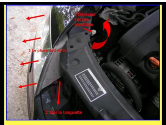
4 Il suffit de prendre le phare et de le tirer vers soi, ensuite il suffit de débrancher le connecteur en s'aidant d'un petit tournevis plat pour déclipser l'ergot
