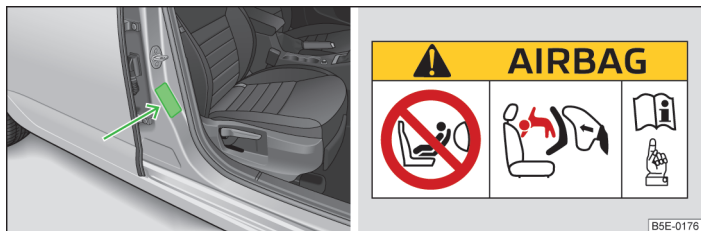
Fig. 166 Autocollant sur le montant B côté passager avant/panneau d'avertissement
