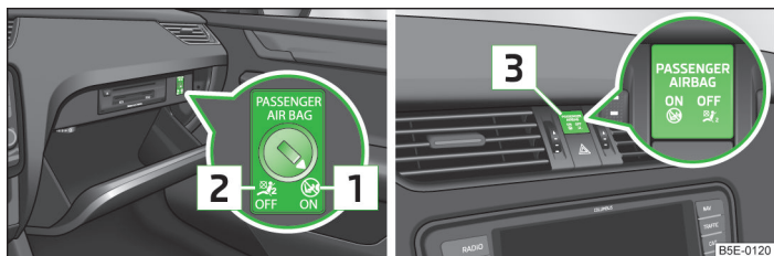
Fig. 164 Commutateur à clé pour l'airbag frontal du passager avant/témoin d'activation/désactivation de l'airbag frontal du passager avant
