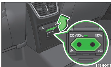
Fig. 73 Console centrale arrière : Prise 230 volts
