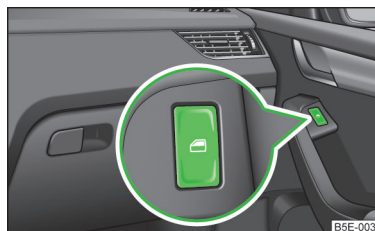
Fig. 24 Position de la touche sur la portière du passager avant
