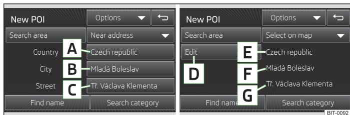
Fig. 40 Recherche de destinations spéciales : dans un rayon autour de l'adresse saisie ou du point défini sur la carte
