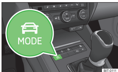
Fig. 47 Console centrale : Touche pour la sélection du mode de conduite
